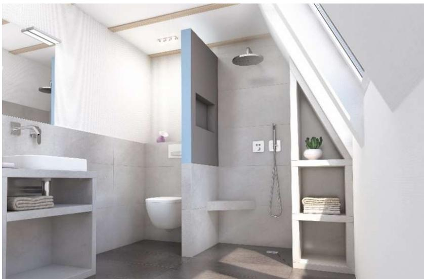
En el elemento wedi Sanwell, el nicho se integra en la fábrica. El sellado complejo, como en las paredes de ladrillo, ya no es necesario, porque ya viene realizado.
